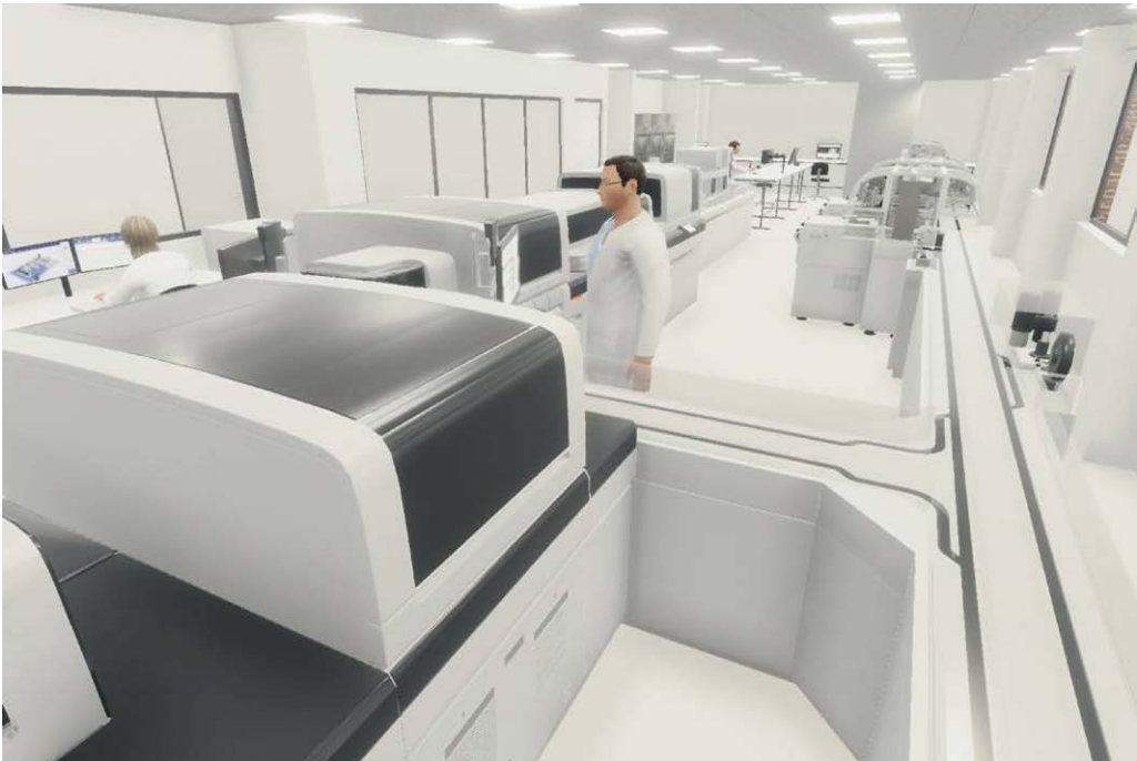
Figuur 0.2: Medisch laboratorium ingericht met total lab automation (TLA)-, waarin diverse analyseplatforms van leverancier Siemens Healthineers gekoppeld zijn aan een Impeco-tracksysteem. Op de track worden de buisjes met bloed of ander patiëntmateriaal automatisch vanuit de input/output-module getransporteerd, voorberekt (centrifugeren), ontdopt, op de diverse platforms geanalyseerd en, als alle uitslagen bekend zijn, met aluminiumfolie afgesloten en enige dagen bewaard in een grote koelkast (storage), die ook met de track is verbonden, alvorens automatisch te worden afgevoerd via een container voor biologisch afval. Bron afbeelding: Klinisch Chemisch en Hematologisch Laboratorium van het Groene Hart Ziekenhuis in Gouda en Siemens Healthineers Nederland BV.
