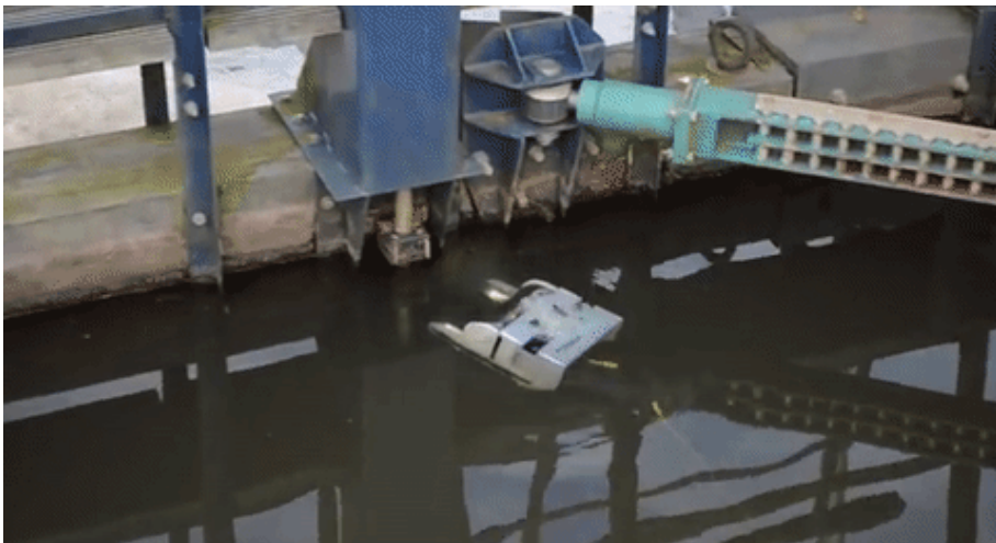
Figuur 5. Onderwaterdrone voor de watersector (boven). Deze wordt onder andere ingezet bij inspectie van sluisen (onder)
